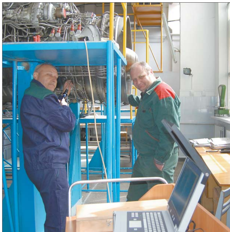
Спеціалісти «Мотора» оглядають двигун ендоскопом
