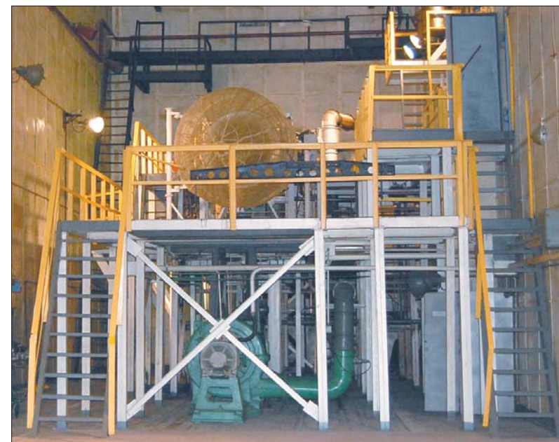
Саме тут випробовують відремонтовані двигуни
